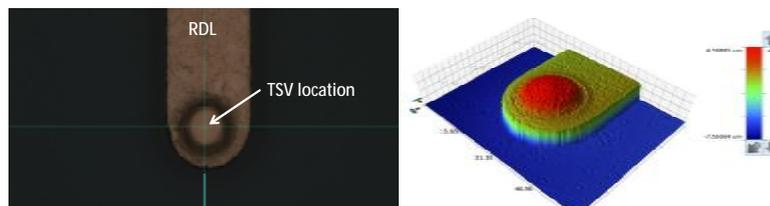
图 4 TSV 背端附近光学照片及三维形貌
